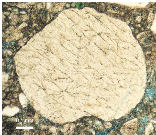
图8 岩石薄片照片, 示非正常沉积的砂、砾岩层中石英颗粒表面的显微变形
